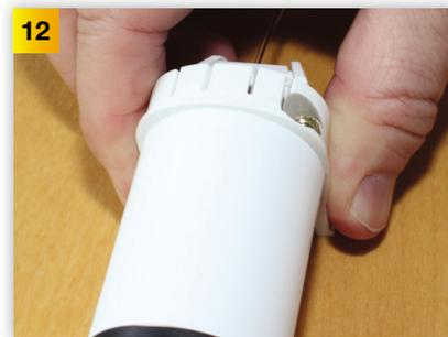
12 Ventileinheit wieder gerade ausrichten. Zeiteinstellschraube wieder herausdrehen (gemerkte Umdrehungen) und Winflip wieder am Fenster befestigen.
