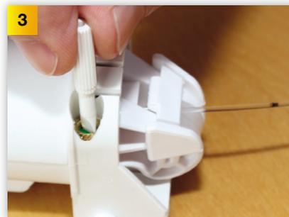
3 Nur bei analoger Version: Drehen Sie die grüne Ventilschraube ganz hinein, damit sich die transparente Schnur nicht gleich wieder einzieht. Tipp: Umdrehungen merken zum Rückstellen.
